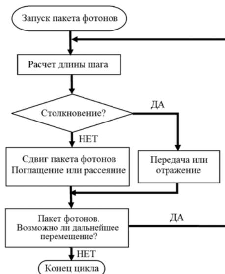
Рис. 2. Блок-схема моделирования методом Монте-Карло процесса распространения света (без изменения длины волны)
