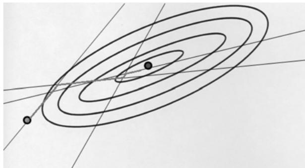
Рис. 8. Минимизация многопараметрической функции методом Флетчера-Пауэлла-Давидона
